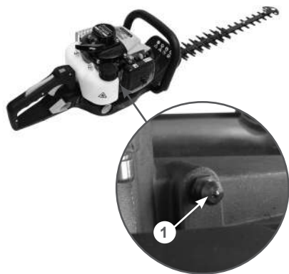
Рис. 16 Расположение пресс-маслёнки 1. Пресс-маслёнка
