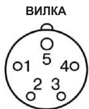
Рис. 4. Схема расположения контактов на вилке
